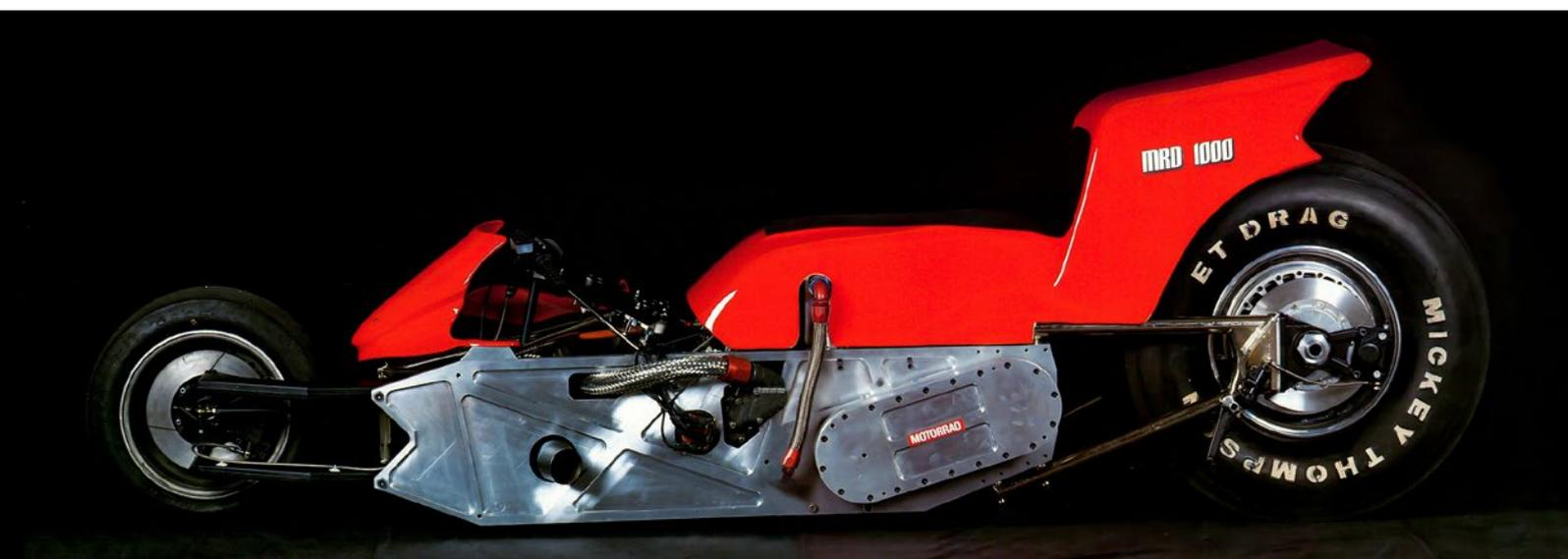
Das war damals der stärkste Formel-1-Motor. Das Vierzylinder-Triebwerk mit Garnet-Abgasturbolader entwickelte bei 10'500U/min eine Leistung von 1050PS.
