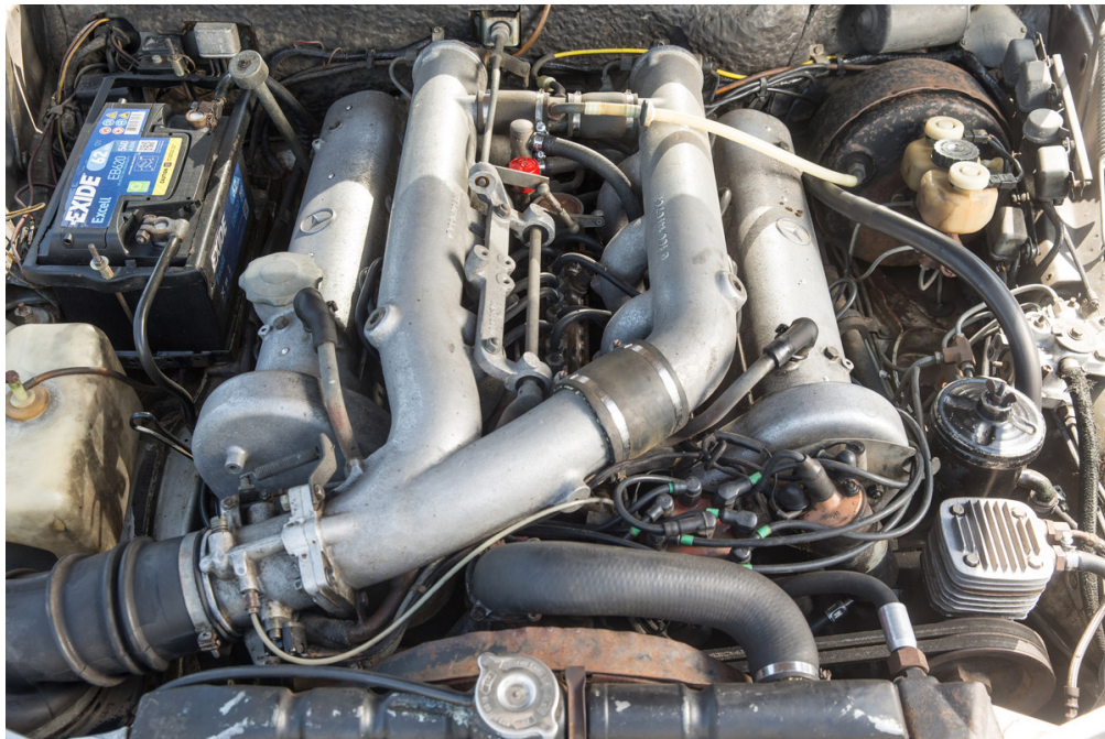
Mercedes-Benz 300 SEL 6.3 (1968) – Ein auf maximale Haltbarkeit ausgelegter Drosselmotor: Mit 40 PS pro Liter ist der V8 nicht ansatzweise ausgereizt Copyright © Daniel Reinhard
