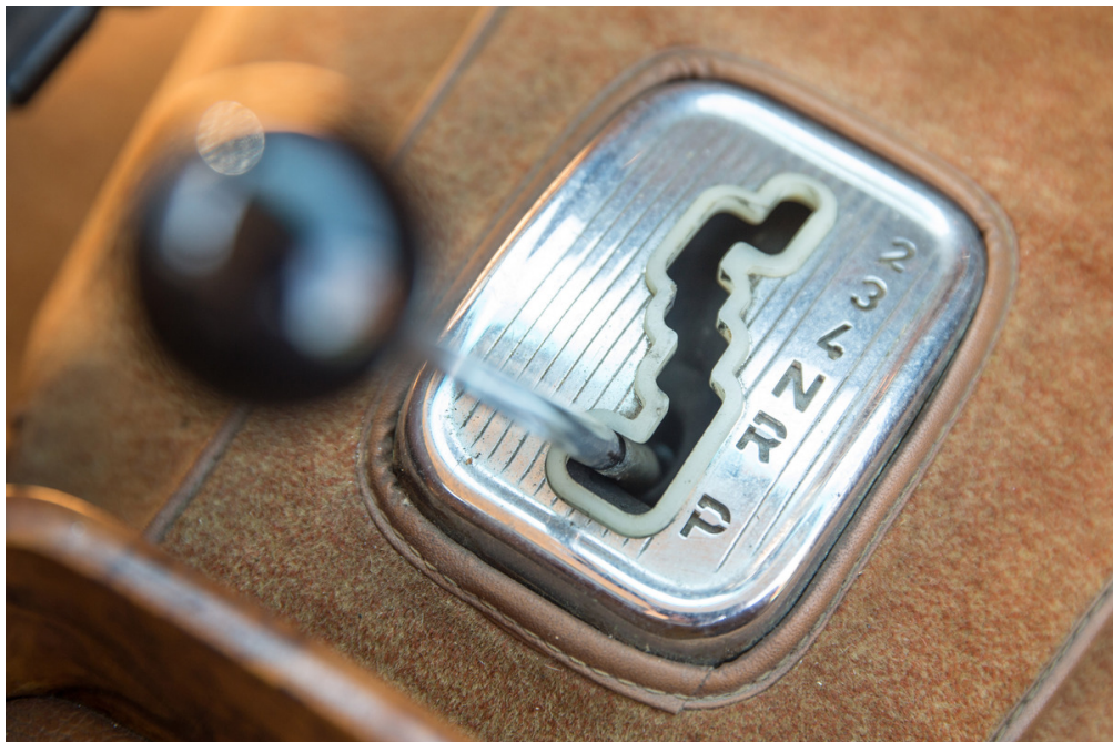
Mercedes-Benz 300 SEL 6.3 (1968) – Typisch Daimler: das Automatikgetriebe mit Ratterkulis und umgekehrtem "Schaltschema" Copyright © Daniel Reinhard
