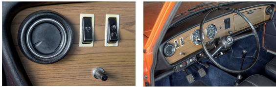
Späte Variante des Austin 1300 mit Rundinstrumenten und Holzarmaturenbrett.
