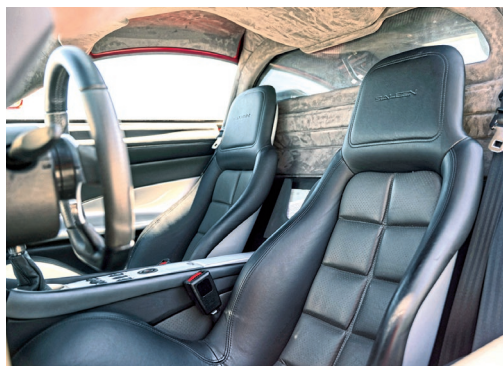
▲ Die Schalensitze sind starr verschraubt und lassen sich nicht einstellen ▼ Der Tacho reicht bis 390 km/h
